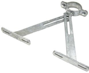
aus Stahl verzinkt, für die Befestigung von zwei Richtungstafeln (VZ 625) flach 500 x 500 mm (Einstellbereich 60 - 110 Grad), inkl. Sechskantschraube, U-Scheibe und Mutter M8x25 mm aus Edelstahl A2, ohne Befestigungsschrauben für VZ
